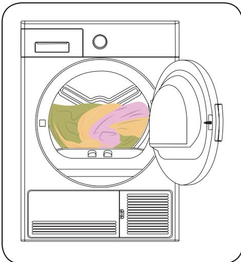
**VAŽNO:** Ne preporučuje se u sušilicu staviti više rublja od količine prikazane u tablici. Kada je pretrpana, performanse sušenja se smanjuju te može doći do oštećenja sušilice i rublja.
